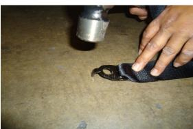
STEP 14: BEFORE ATTACHING SHOULDER HARNESS TO THE OUTBOARD SIDE OF THE SEAT, TAB MUST BE BENT FLAT.
