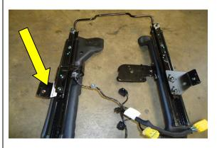
STEP 7: PLACE THE (2) SPACERS ON THE FRONT MOUNTING BOLTS, THEN THE LARGER BRACKET ON THE OUTBOARD SIDE OF THE ADJUSTER AND THE SMALLER BRACKET ON THE INBOARD SIDE.
